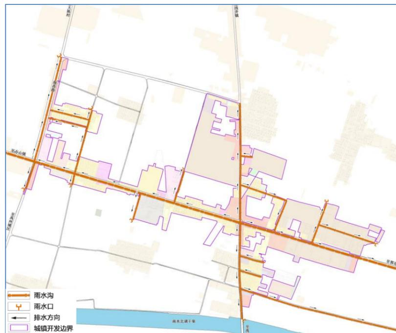
雨水边沟采用300\*400mm，沿道路布置，采用重力流收集原则，就近排放。
